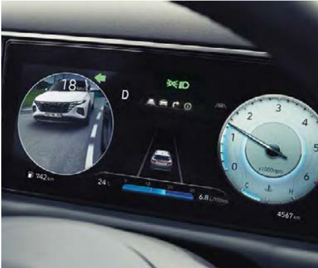
Totwinkelassistent mit Monitoranzeige (BVM) Spurwechsel sicher und einfach gemacht: Im digitalen Cockpit wird Ihnen per Kameraübertragung der tote Winkel angezeigt. Die Kameras werden über den Blinker aktiviert.
